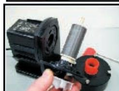
behuizing niet op de rotoras valt (breukgevaar). Na het onderhoud aan de pomp, kunt u de 4 schroeven kruislings, licht aandraaien, tot de spleet tussen de behuizing en de pomp gesloten is. Let op: schroeven niet te vast aandraaien, de behuizing is van kunststof!
